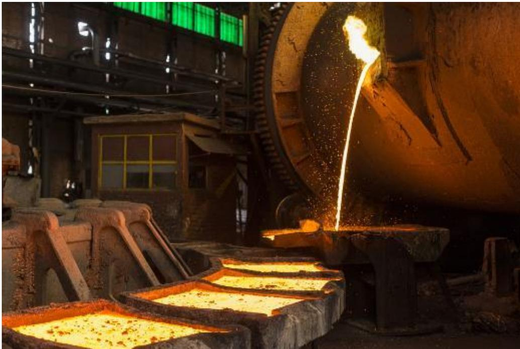
Ilustración 23. Proceso de Pirorrefinación y moldeo de ánodos. Fuente: [38].
