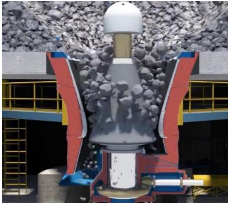
Ilustración 6. Chancador primario giratorio. Fuente: [2].
