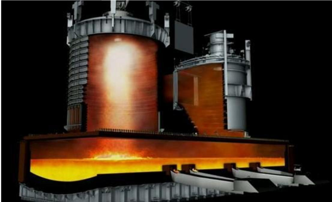
Figura. Horno fusión flash. Fuente: Revista Minería Chilena.
