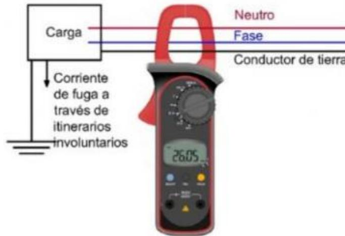
Figura. Medición de fugas de corriente a través de itinerarios a tierra involuntarios. Fuente: Blog Certicalia
