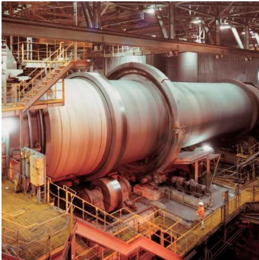
Ilustración 19. Horno de Secado. Fuente: [31]
