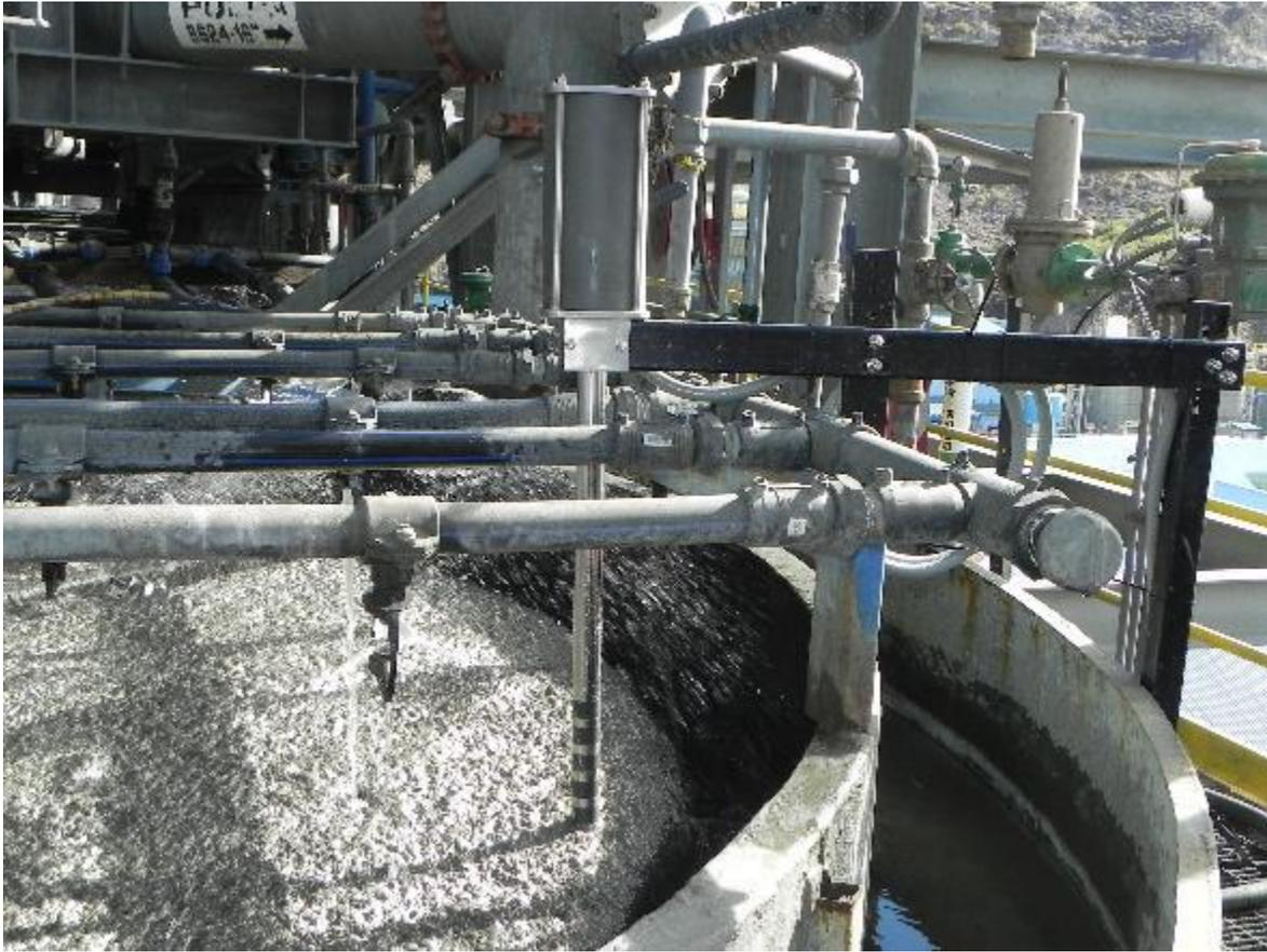
Ilustración 15. Proceso de flotación. Fuente: [23].
