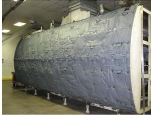
Figura. Aislamiento térmico en horno. Fuente: Procoen.
