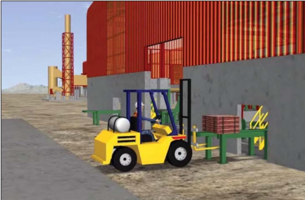
**Figura A1.20: Grúa horquilla esperando un paquete de cobre proveniente de las máquinas lavadoras-despegadoras de cátodos.**
