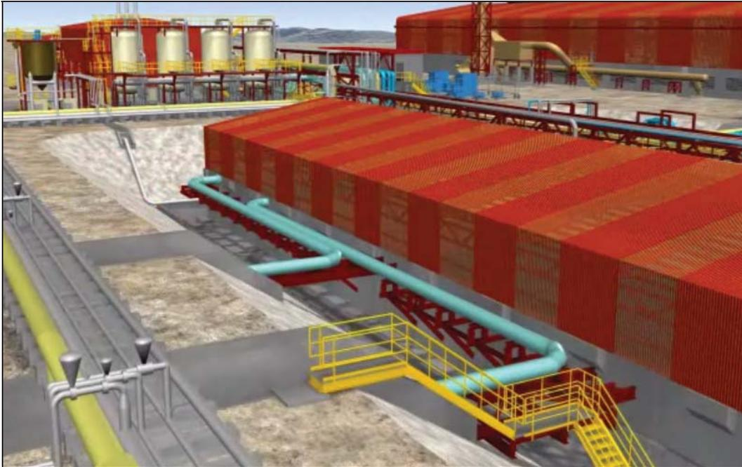
Figura A1.11: Estanque de electrolito rico, encargado de almacenar el electrolito cargado proveniente de SX.
