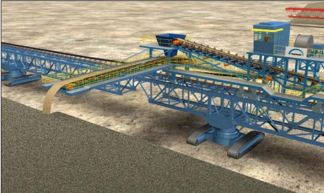
Figura A1.4: Puente apilador formando la pila de lixiviación.
