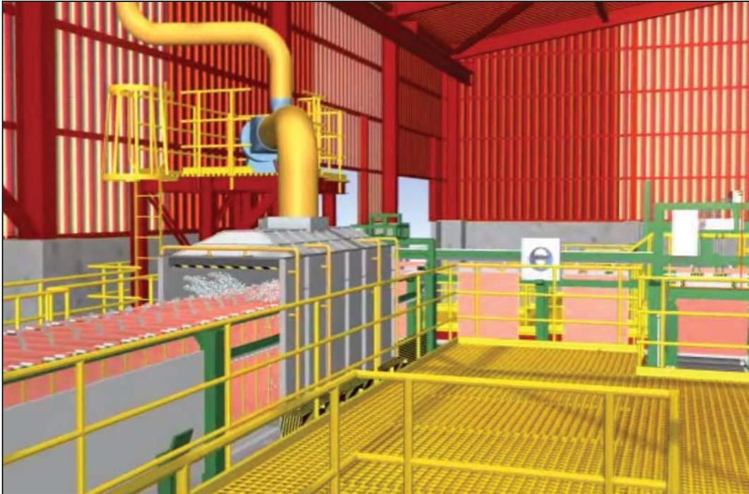
Figura A1.18: A la izquierda, se aprecia la máquina lavadora de cátodos.
