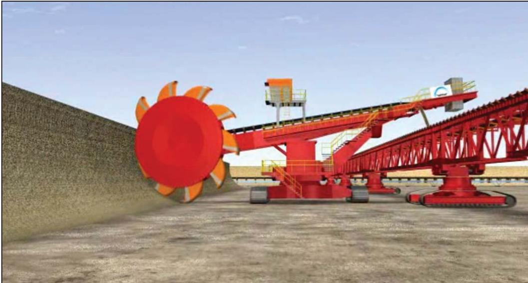
**Figura A1.6: Rotopala utilizada para retirar el mineral lixiviado.**
