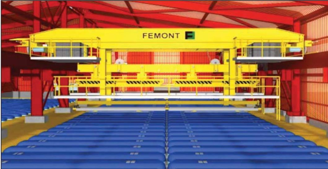
Figura A1.15: Puente grúa utilizado para el traslado de cátodos de cobre en la nave de EW.
