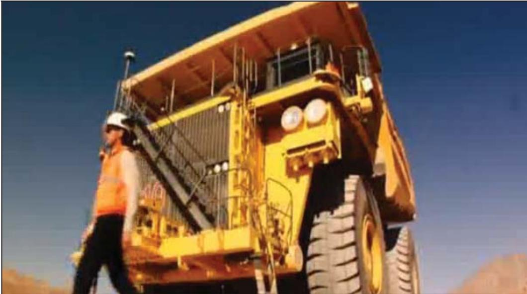
Figura A1.1: Camiones autónomos Komatsu 930E utilizados en la Mina.
