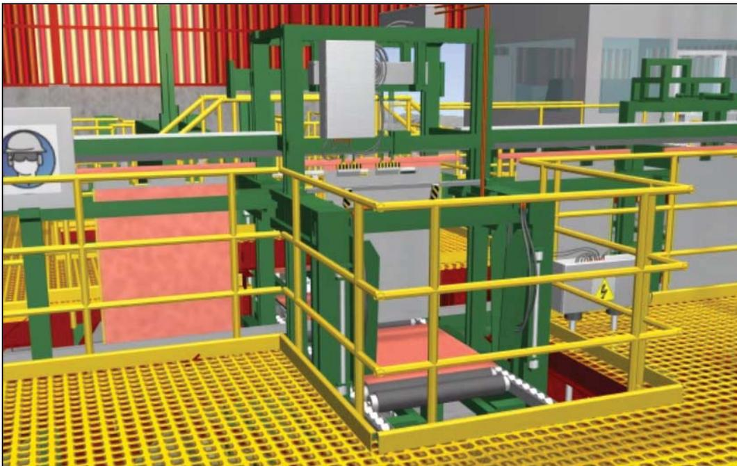
Figura A1.19: Máquina encargada de despegar las láminas de cobre de los cátodos.
