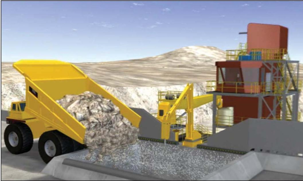
Figura A1.2: Descarga de material desde camión autónomo al buzón de recepción de mineral grueso.
