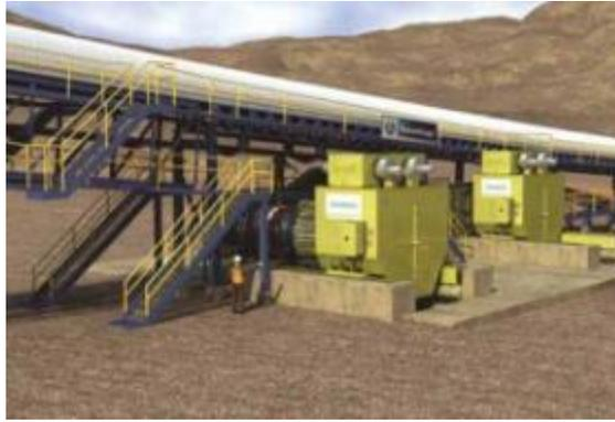
**Figura: Accionamiento gearless en correas transportadoras. Fuente: Revista Minería Chilena**
