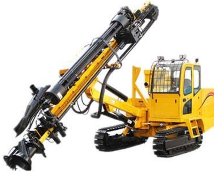
Perforadora con martillo en fondo. Fuente: <https://es.rotarypercussivedrill.com/Products/Perforadoras-DTH.html>
