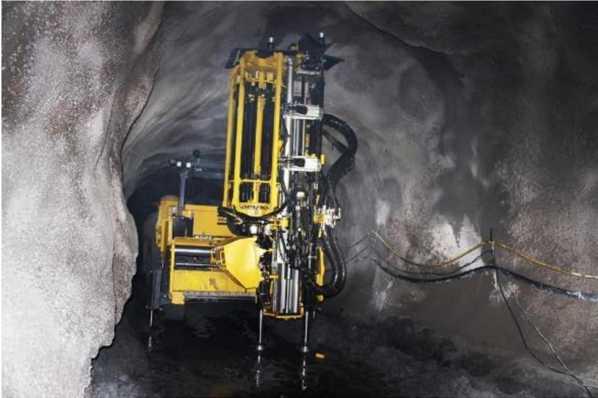
Ilustración 6. Perforadora electrohidráulica empleada en minería subterránea [4].
