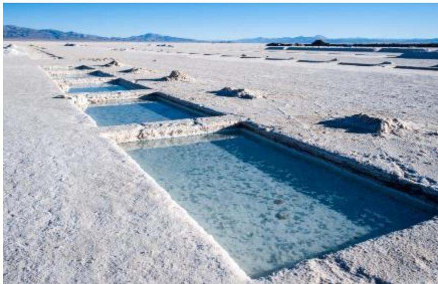
Ilustración 13. Piscinas de evaporación solar.
