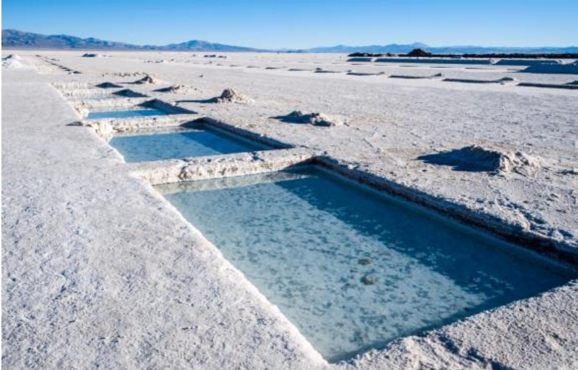
Ilustración 10. Piscinas de evaporación solar.
