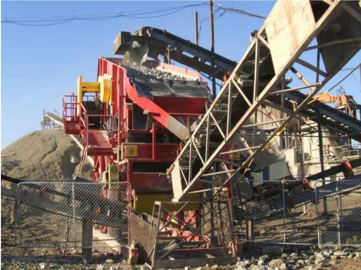
Ilustración 8. Harnero vibratorio en funcionamiento. Fuente: [8].
