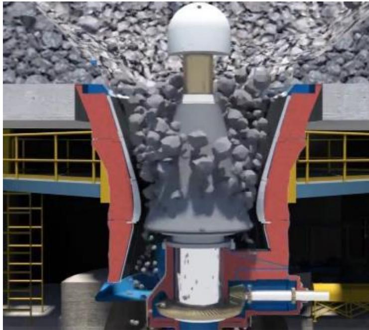
Ilustración 6. Chancador primario giratorio. Fuente: [2].
