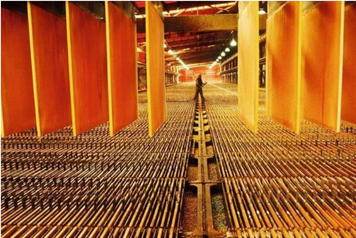
Figura: Planta de electroobtención. Fuente: Camiper – Cámara minera del Perú
