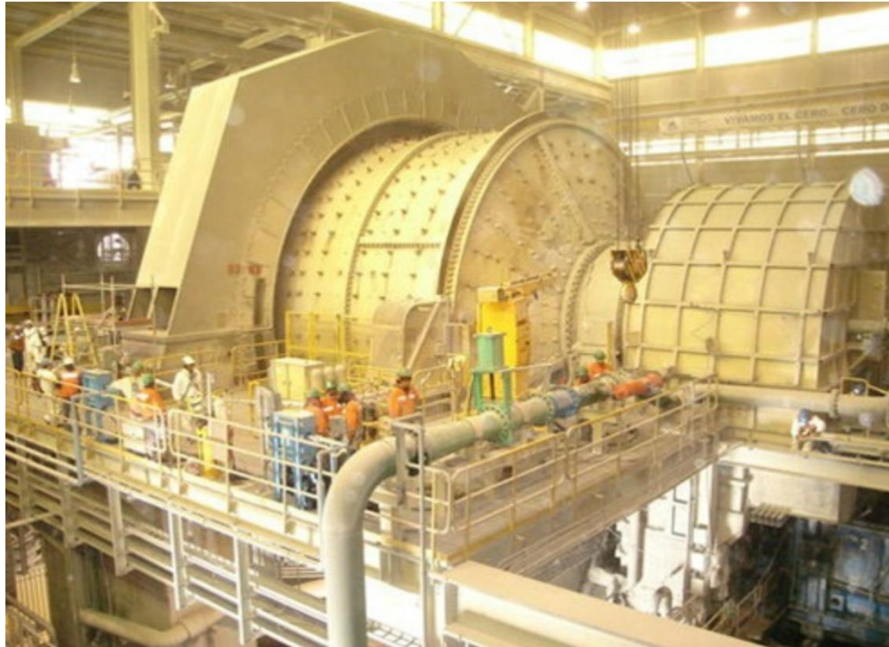
Figura 7. Imagen molino SAG (semiautógeno). Fuente:
