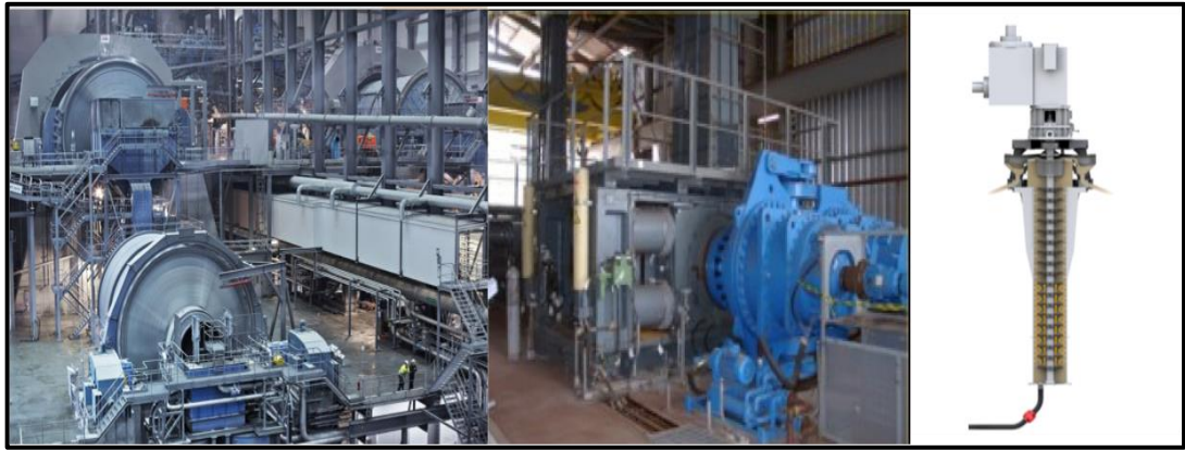
Figura 9. A Molienda autógena. B Rodillos de molienda. C Molino agitado vertical.
